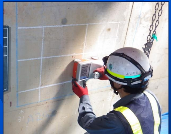
配筋調査(ストラクチャスキャン)
